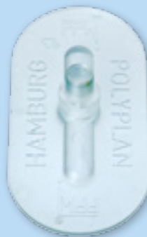
Klebepacker oval (1131 A)< Größe 50 x 100 mm, aus durchsichtigem Polycarbonat, Außengewinde M 10 x 1,0 Gewicht ca. 15 g
