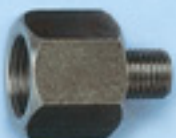
(1031 RF) Gewinde innen G 3/8", Gewinde außen M 10 x 1,0, passend zw. Packer (1031), Nippel (1120), Hähne (1170)
