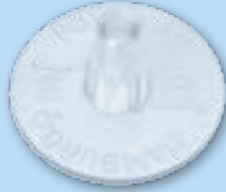
Klebepacker rund (1138)< aus durchsichtigem Polycarbonat, 48 mm Ø, Innengewinde M 8 x 1,0 Gewicht ca. 7 g
