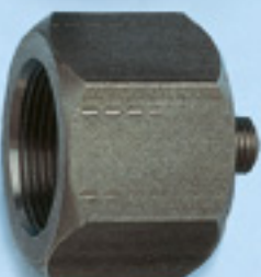
(1049 RF) Gewinde innen G 1" zu Gewinde außen M 10 x 1,0 passend zw. Packer (1049) und Nippel (1120)
