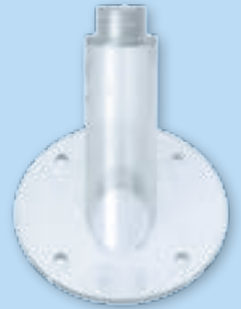
Klebepacker rund (1135)< aus durchsichtigem Poly- carbonat, mit schrägem Einpressstutzen, Innengewinde M 8 x 1,0 Gewicht ca. 8 g
